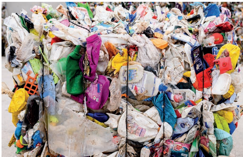
Zu Ballen komprimiert warten die Leichtverpackungen auf den Weg in die Verwertungsanlage.
