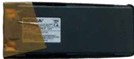
Die Pole der Akkus müssen mit Klebeband abgedeckt werden, um Kurzschlüsse zu vermeiden, die zum Brand führen können.
