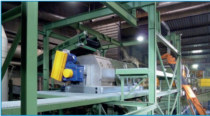
Die Schneckenpresse, zentrales Aggregat der Presswassererzeugung.
