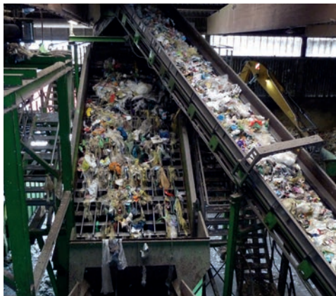
Der Inhalt der Gelben Säcke wird auf der „Dosierplatte“ entzerrt.
