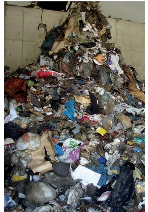
*So sieht heizwertreiches Material aus Restmüll vor der weiteren Aufbereitung zu „BauhM“ aus. In dieser Form und Zusammensetzung kann es nur in Müllverbrennungsanlagen thermisch verwertet werden.*
