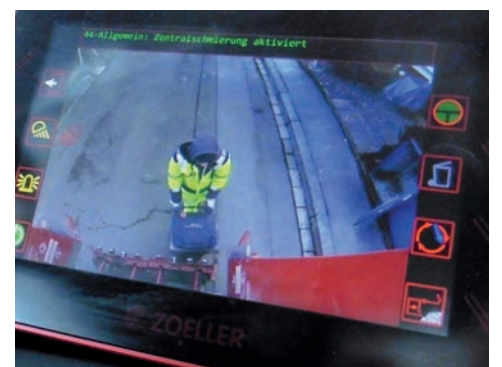
Unerlässlich für sicheres Arbeiten hinter dem Fahrzeug ist die rückwärtige Kamera.
